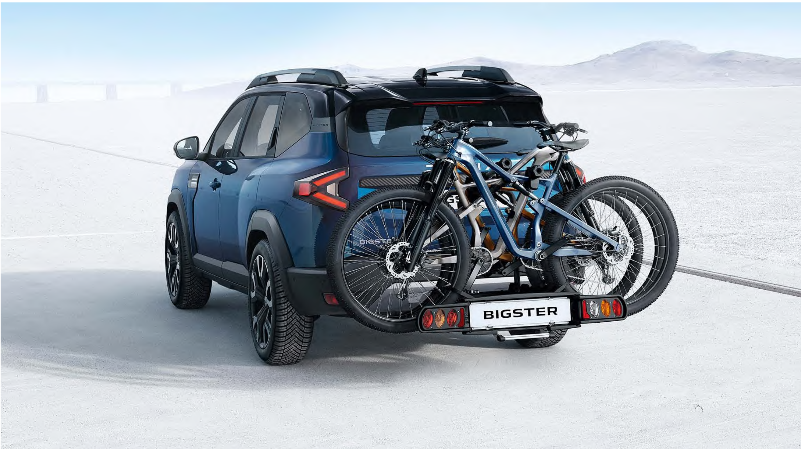
VELOSIPĒDU TURĒTĀJA PLATFORMA 3 VELOSIPĒDIEM, KAS UZMONTĒTA UZ VILCES ĀĶA
